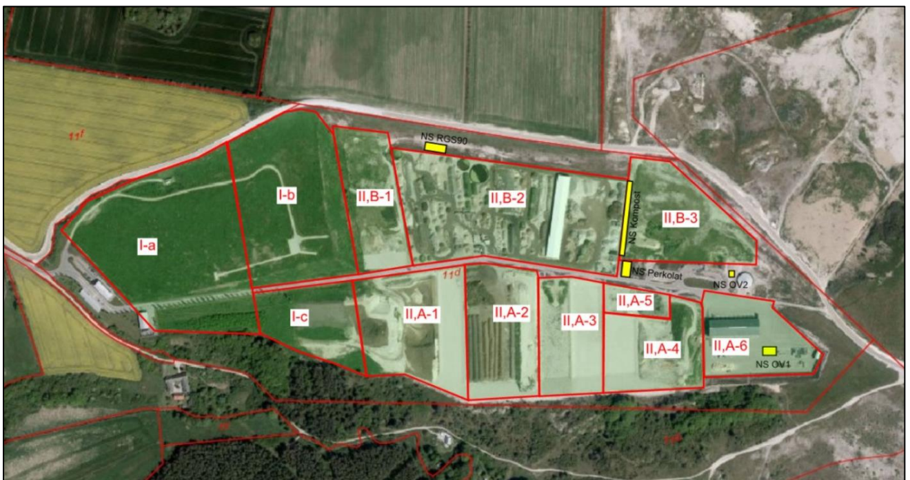
Figur 1: Oversigtsplan over Reno Djurs' deponeringsanlæg, der viser section II, A-1 (enhederne A, B og M med shredderaffald) og section II, A-4 (enhederne J, K og L med blandet affald).
